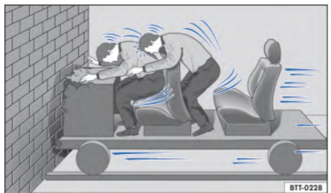
Рисунок 28. Ситуация, когда автомобиль с не пристегнутым пассажиром врезается в кирпичную стену
