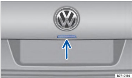
Рис. 63 Закрытая дверь багажного отделения: кнопка электрического открывания двери багажного отделения (схематическое изображение)
