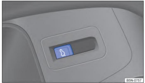
Рисунок 61 На двери водителя: кнопка отпирания двери багажника
