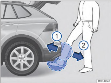
Рис. 66 Индуктивная крышка багажника (Easy Close) (схематическая диаграмма)
