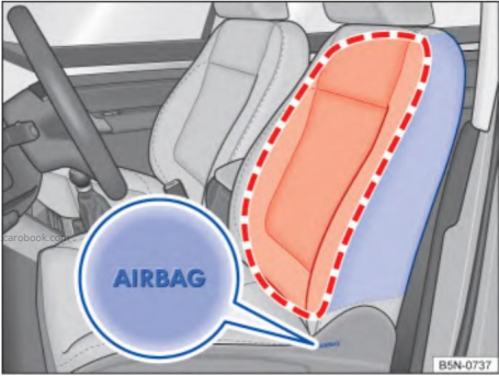
Рис. 40 Боковая часть левого переднего сиденья: положение установки и диапазон раскрытия боковой подушки безопасности
