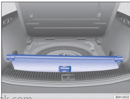
Рис. 162 Под полом багажного отделения: хранение шторки багажного отделения
