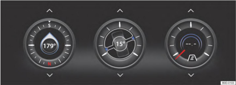
Рис. 117 В информационно-развлекательной системе: индикация внедорожной информации.
