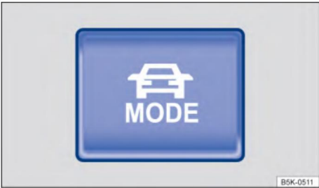
Рис. 115 Нижняя часть центральной консоли: кнопка выбора режима движения для переднеприводных моделей
