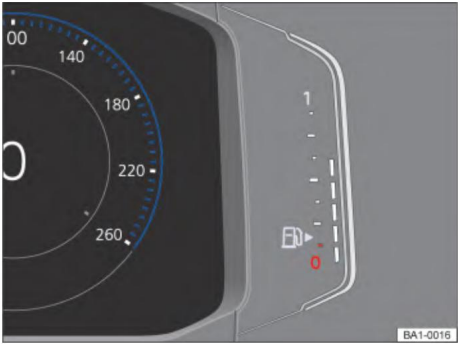
Рис. 19 Цифровая комбинация приборов: указатель уровня топлива
