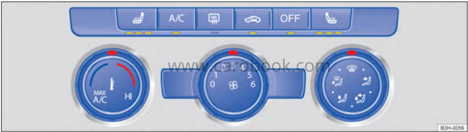
Рис. 99 Верхняя часть центральной консоли: привод полуавтоматической системы кондиционирования воздуха
