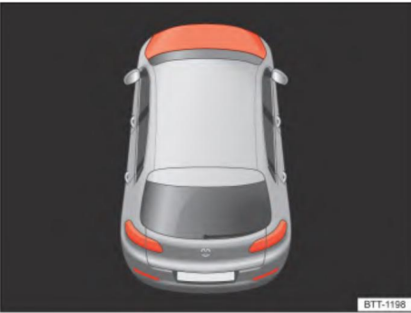
Рис. 186 Индикация комбинации приборов: капот открыт или закрыт неправильно (принципиальная диаграмма)
