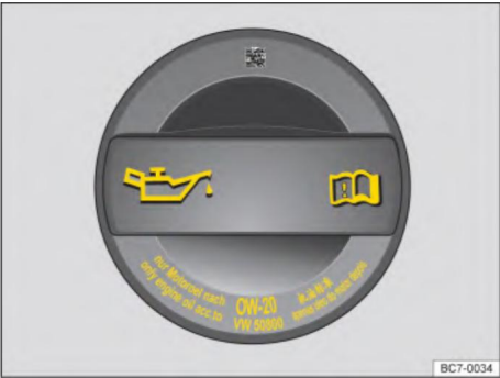
Рисунок 189 Маркировка на крышке масляной горловины (схематическое изображение): Тип 2
