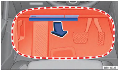
Рис. 43 Сторона водителя: Зона действия коленной подушки безопасности.
