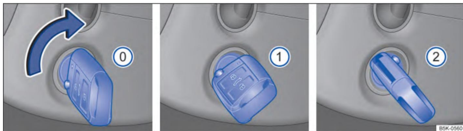
Рис. 106 Правая сторона рулевого колеса: положение ключа автомобиля в замке зажигания
