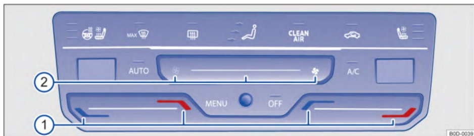
Рис. 100 Верхняя часть центральной консоли: привод полностью автоматической системы кондиционирования воздуха (принципиальное изображение)
