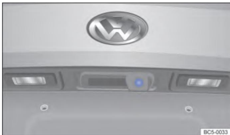
Рисунок 212 В крышке багажника: ручка открывания двери задка, камера заднего вида (схематическая схема)
