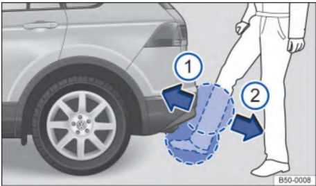
Рисунок 65. Индуктивная задняя дверь (Easy Open) (схематическая диаграмма)
