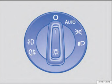
Рис. 87. Радом с рулевым колесом: переключатель света (данный тип приведен только в качестве примера)
