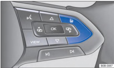
Рис. 101 На multifunctional рулевом колесе: кнопка обогрева рулевого колеса
