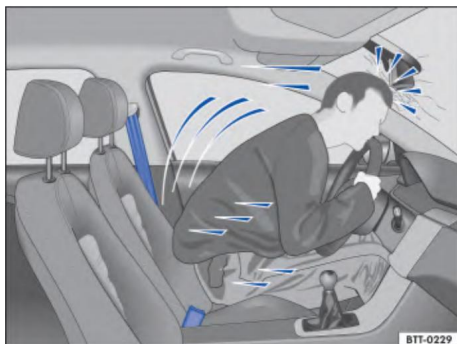
Рис. 29 Водитель, который не был пристегнут ремнем безопасности во время столкновения, резко выброшен вперед
