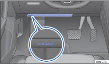
Рисунок 42. Сторона водителя: место установки коленной подушки безопасности.
