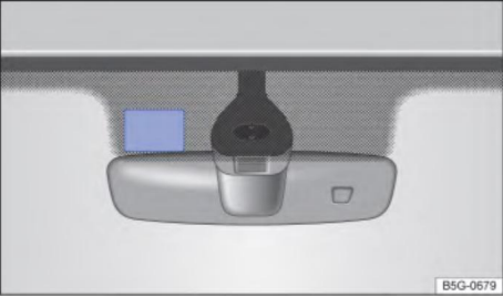
Рисунок 213 Коммуникационное окно на лобовом стекле (синяя область) (схематическое изображение)
