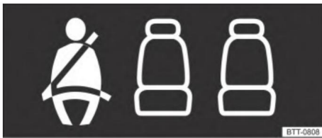
Рисунок 26 На дисплее щитка приборов: индикатор состояния заднего ремня безопасности
