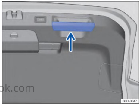
Рис. 62 Открытая дверь багажного отделения: ручка для закрывания двери багажного отделения
