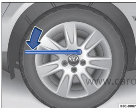
Рис. 207 Замена колеса: ослабьте колесные болты
