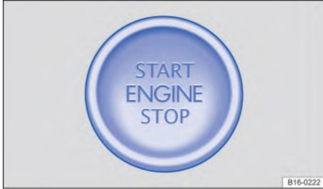
Рис. 107 Нижняя часть центральной консоли: кнопка Start/Stop для запуска двигателя
