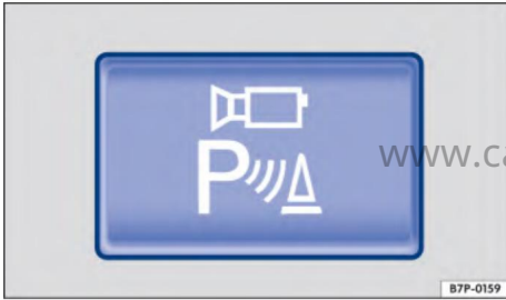
Рис. 145 На центральной консоли: кнопка ручного включения системы панорамных камер
