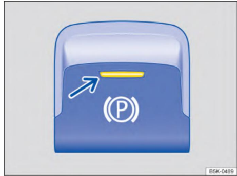
Рис. 131 На центральной консоли: кнопка электронного стояночного тормоза
