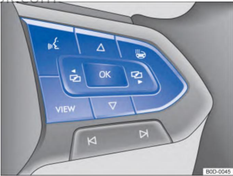
Рисунок 23 Правая часть multifunctional рулевого колеса: кнопки управления меню комбинации приборов и информационного дисплея
