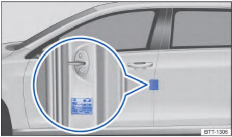
Рис. 200 На стойке двери со стороны водителя: табличка с указанием давления в шинах
