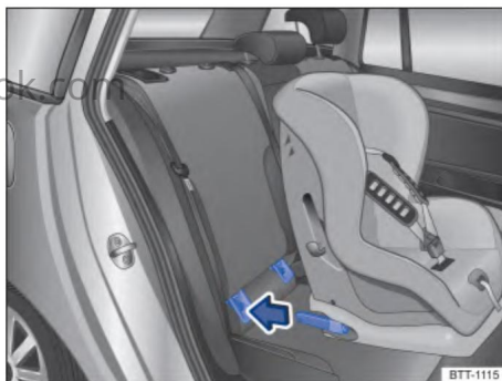
Рис. 47 Схема: Установка детского сиденья ISOFIX с помощью фиксирующих рычагов
