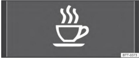
Рис. 17 Дисплей комбинированного прибора: символ предупреждения об усталости
