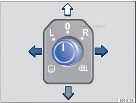
Рис. 96 Дверь со стороны водителя: ручка регулировки наружного зеркала заднего вида
