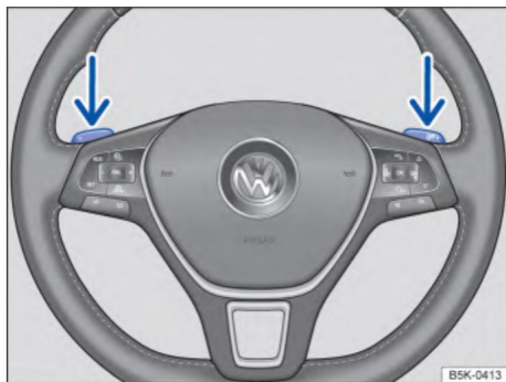
Рис. 112 Рулевое колесо с двумя кулисными переключателями для программы переключения Tiptronic (принципиальное изображение)
