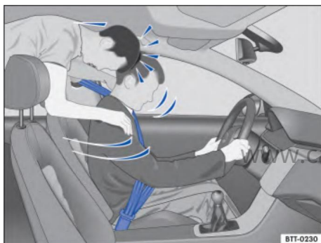
Рис. 30 Пассажиры сиди, которые не были пристегнуты ремнями безопасности в момент столкновения, были сильно выброшены вперед и ударились о рулевое колесо, пристегнутого ремнями безопасности.
