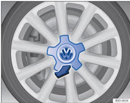
Рисунок 205. Отсоедините центральную крышку колеса.
