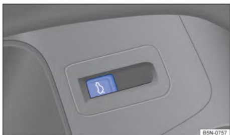
Рис. 56 Дверь со стороны водителя: кнопка отпирания двери багажного отделения
