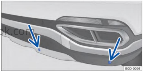
Рисунок 134. На заднем бампере: Ультразвуковой датчик заднего парковочного радара (Tan Yue X)
