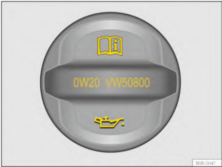
Рис. 191 Внутри моторного отака: крышка заливной горловины моторного масла (принципиальное изображение)
