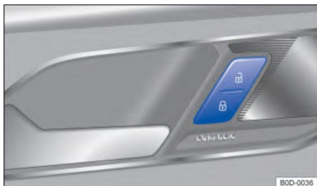
Рис. 55 Дверь со стороны водителя: кнопка центрального замка
