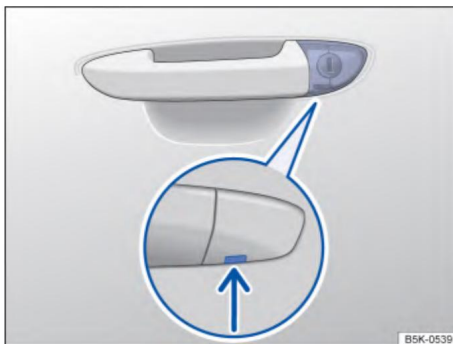
Рис. 57 Ручка двери со стороны водителя: личинка скрытого дверного замка
