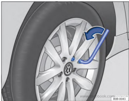
Рис. 210 Замена колеса: Снимите колесные болты с помощью торцевого ключа для колесных болтов.
