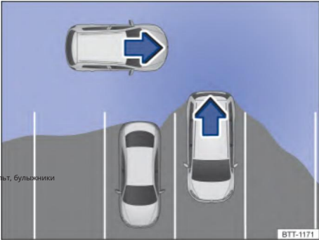
Рисунок 143. Принципиальная схема помощи при парковке: зона контроля окружающей среды при выезде автомобиля с парковочного места
