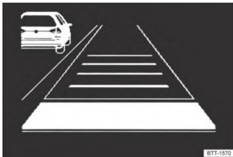
Рисунок 124 На дисплее комбинации приборов: распознано, что скорость автомобиля в левой полосе ниже, чем у собственного автомобиля (принципиальная диаграмма)
