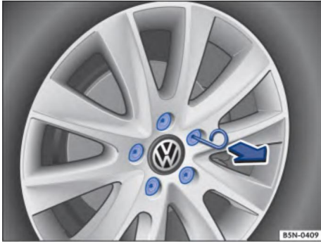
Рис. 206 Снять защитный колпачок с колесного болта
